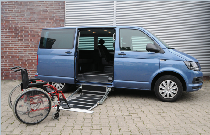
Die seitliche Auffahrmöglichkeit mit der flachen Seitenkante der Liftplattform spart Platz bei der Auffahrt mit dem Rollstuhl.
